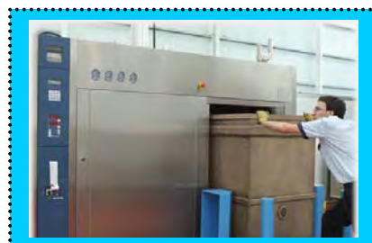
IMAGEN 15. Tratamiento mediante la esterilización en la autoclave.
