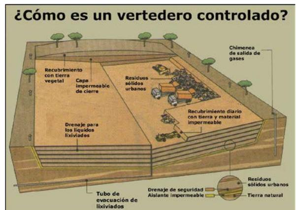
**FOTO 2:** diseño de un vertedero controlado.
