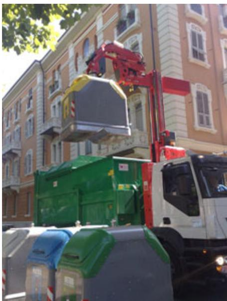
**FOTO 3.** Contenedor siendo recogido por camión de la basura
