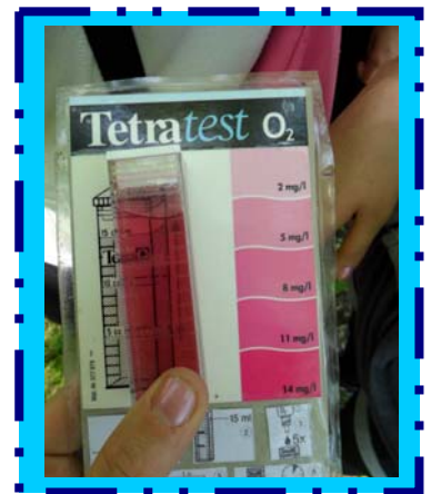
FOTO 17.- Oxígeno disuelto en la zona 5.
