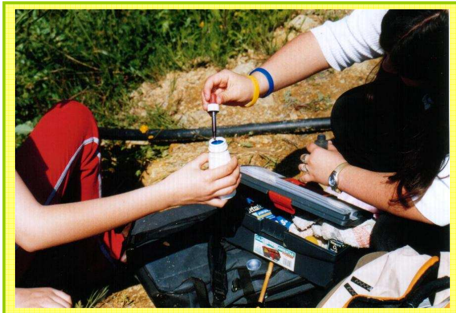
FOTO 18. Prueba azul de metileno, afluente punto 1.
