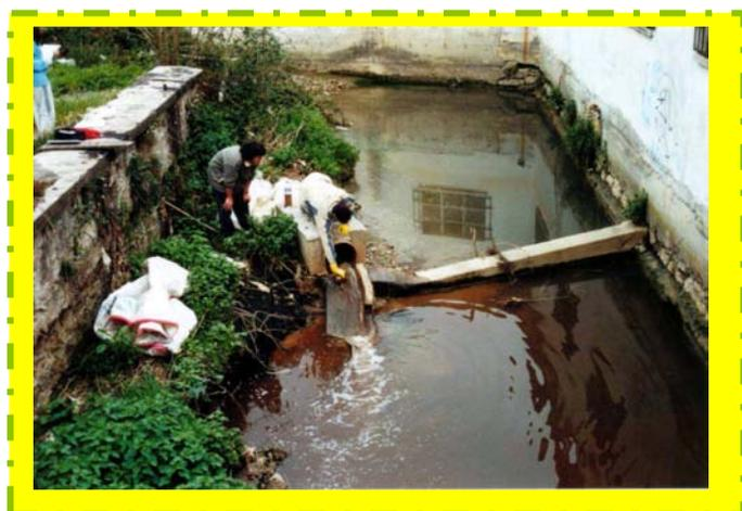
**FOTO 15.** Tubería del punto 6, salida de los lixiviados del vertedero de R.S.U. San Marcos.
