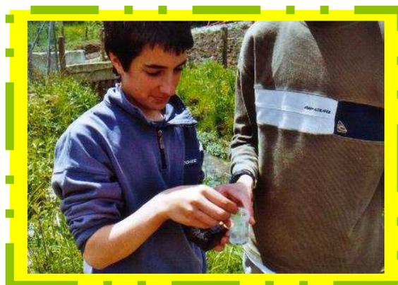
**FOTO 16.** Prueba del azul de metileno para comprobar la presencia de materia orgánica en el agua.
