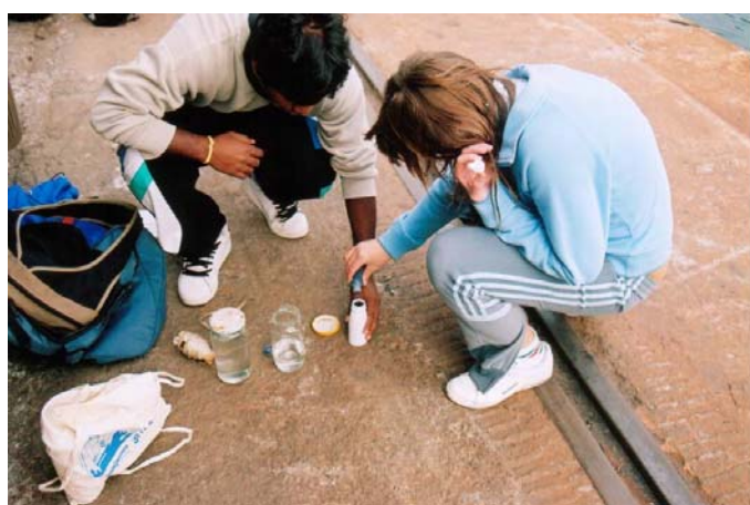
FOTO 26. Prueba del azul de metileno; determina la presencia de materia orgánica en el agua.
