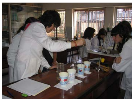
FOTO 27. Prueba del permanganato potásico. Determina presencia de materia orgánica.
