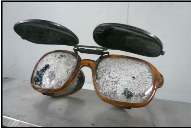
Gafas de seguridad después de haberseles derramado unas gotas de hierro fundido
