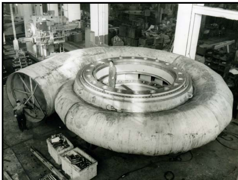
Fabricación de cámaras espirales de turbinas hidráulicas
