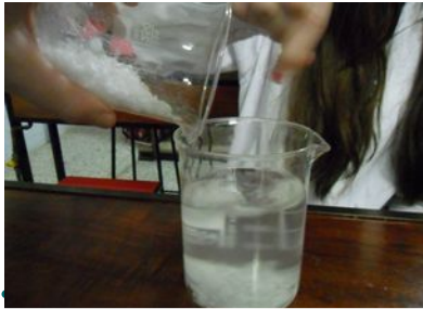
IMÁGEN 22. Disolución de Sosa caustica y agua destilada.
