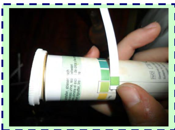
FOTO 43. Comparando el resultado con el solucionario del envase.
