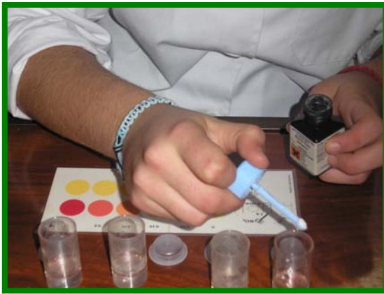
FOTOS 43 y 44. Determinación de nitritos en el laboratorio.
