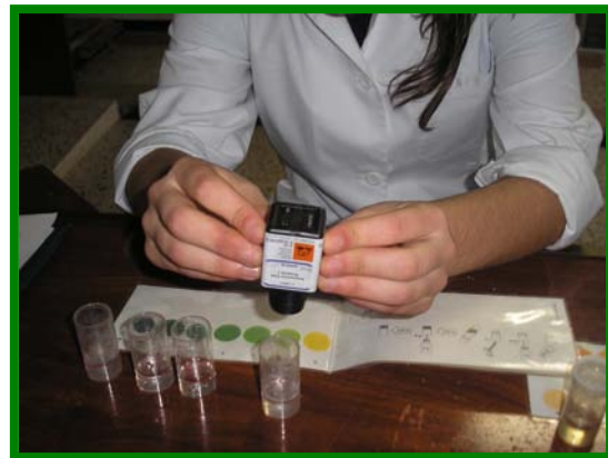
FOTOS 45 y 46. Determinación de amoníaco en el laboratorio.
