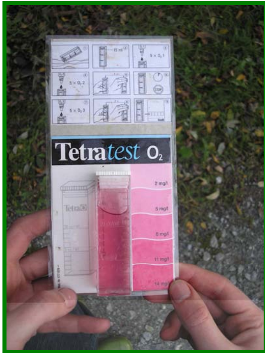
FOTO 52. Comprobación de la concentración de oxígeno disuelto.
