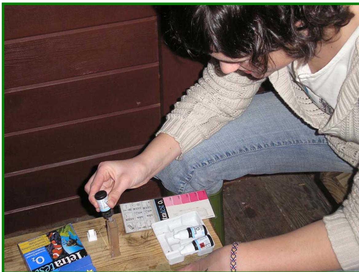
FOTO 47. Determinación de O 2 disuelto en la laguna de Txoritegi.
