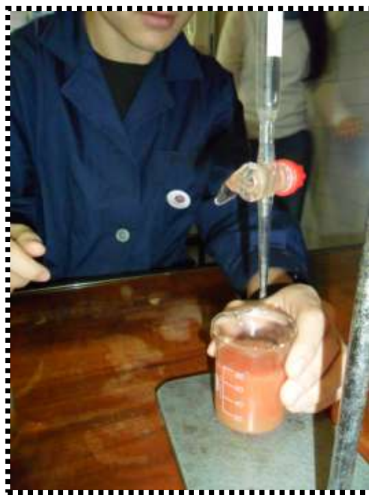
FOTO 4. Realizando el análisis de salinidad.
