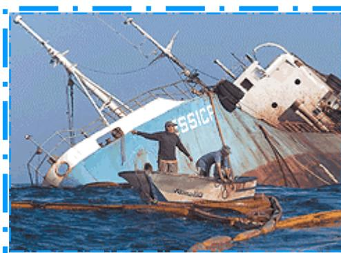
**FOTO 15.** Barrera de contención del vertido del petrolero Jessica.
