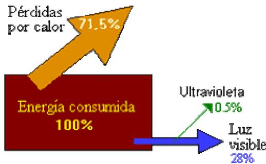
**IMAGEN 7.** Balance energético de una lámpara fluorescente.
