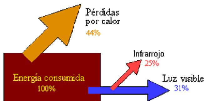
**IMAGEN 11.** Balance energético de una lámpara de vapor de sodio a baja presión.
