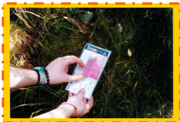
**FOTO 17.** Prueba del O<sub>2</sub> disuelto.
