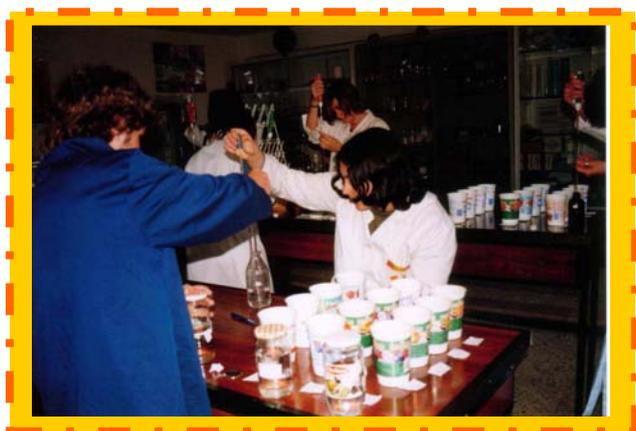
**FOTO 19.** Realizando la prueba del permanganato potásico (materia orgánica).
